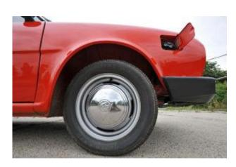
Getankt wird beim S110R vorn - wie bei allen Heckmotor-Skoda.
