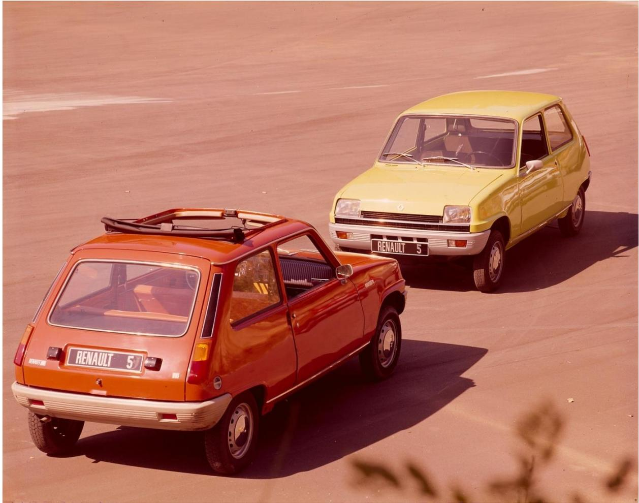
Renault R5 - 1972 präsentierte Renault die erste Generation des R5 als modernen, 3,5 Meter langen Kleinwagen mit Frontantrieb und steiler Heckklappe. (© Renault)
