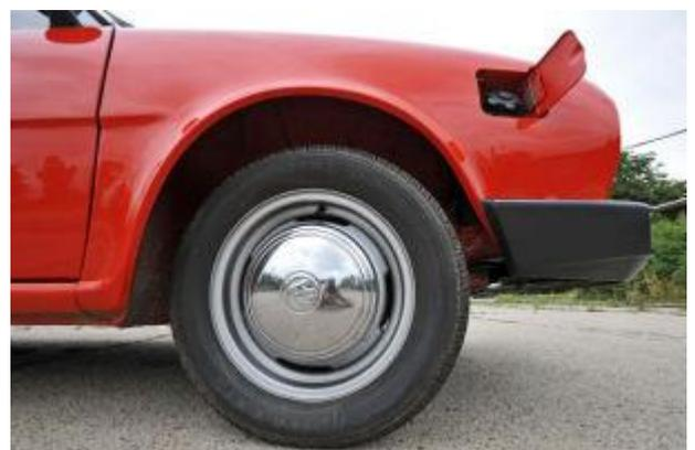
Getankt wird beim S110R vorn – wie bei allen Heckmotor-Skoda.
